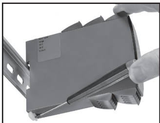
Abb. 1: Das Gerät wird von der DIN-Schiene gelöst, indem man den unteren Verschluss löst.
